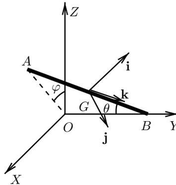
Las ecuaciones diferenciales del movimiento se obtendrán a partir de la función Lagrangiana. Las coordenadas del centro de masas de la varilla en los ejes  $OXYZ$  son:
