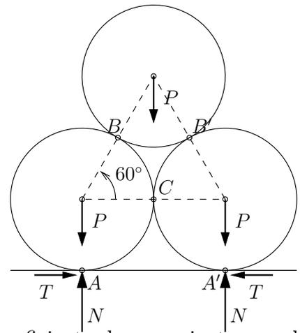
Dado que el agotamiento del rozamiento viene dado por  $T/N = \mu$ , se producirá en el contacto con mayor valor de la relación  $T/N$ . Aislamos uno de los tubos inferiores sujeto a  $T, N$  en  $A$  y  $T', N'$  en  $B$ . Planteando el equilibrio de momentos en el centro deducimos fácilmente que debe ser  $T = T'$ . Planteando el equilibrio de fuerzas horizontales y verticales,
