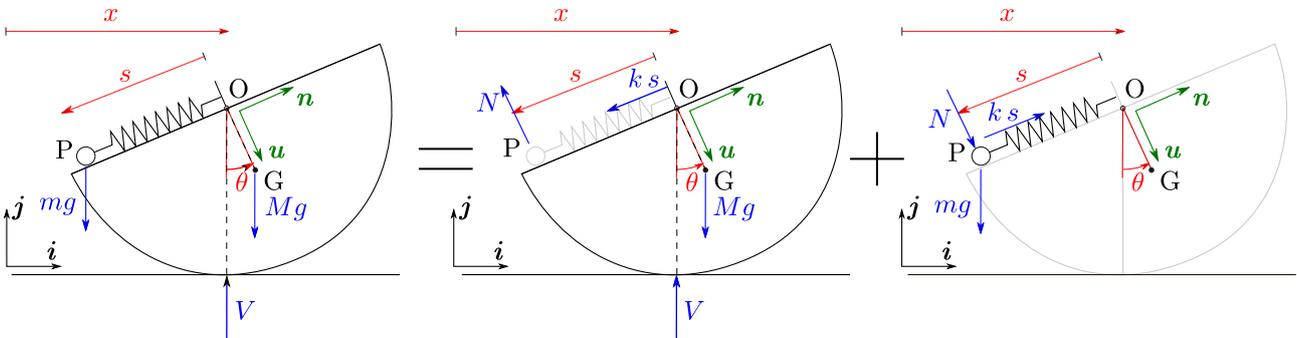
1.— Debido a que el semidisco desliza libremente los grados de libertad necesarios para definir la posición del sistema son  $\{x, \theta, s\}$ , siendo  $x$  el desplazamiento del centro del semidisco según la dirección horizontal,  $\theta$  el ángulo girado por el semidisco y  $s$  la elongación del resorte.
