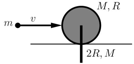
1. Cuando el sistema se encuentra en equilibrio estable, una partícula de masa  $m$  impacta horizontalmente con velocidad  $v$  en el disco a la altura de su centro, observándose que la velocidad de la partícula se anula tras el impacto. Calcular las velocidades del disco y varilla después del choque así como las percusiones reactivas, para lo que se podrá considerar que todas las percusiones son simultáneas.
