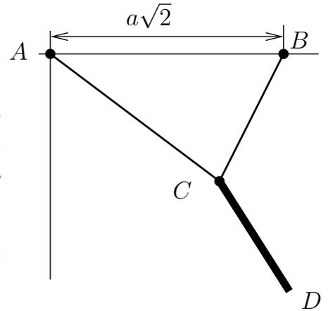
1. Plantear las ecuaciones de la estática que conducen a la resolución del problema y que permiten determinar las posiciones de equilibrio y la reacción en el extremo  $C$ .
