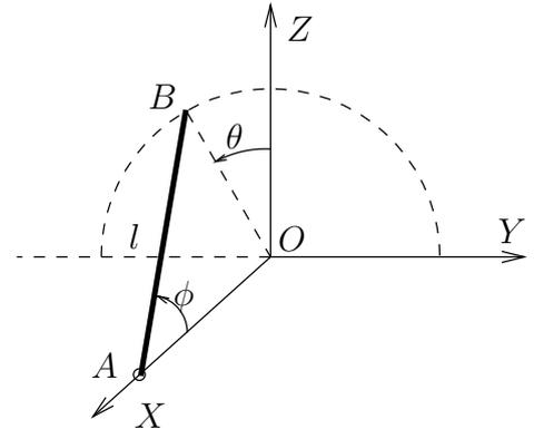
1. Se trata del movimiento de un sólido rígido con un punto fijo  $A$ . Se comprueba fácilmente que la barra sólo posee un grado de libertad  $\theta$  dado que  $\phi$  es constante a lo largo del movimiento. La ecuación del movimiento se obtiene a partir del principio del momento cinético en  $A$ :
