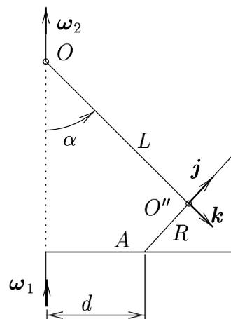
5.- El momento en  $O$  de las fuerzas aplicadas sobre el disco es el mismo que el de las fuerzas aplicadas sobre el sólido rígido formado por el disco y el eje  $OO''$ . Ésto es debido a que el eje  $OO''$  no tiene masa, y la reacción de éste sobre el disco lleva la dirección del propio eje  $OO''$ .
