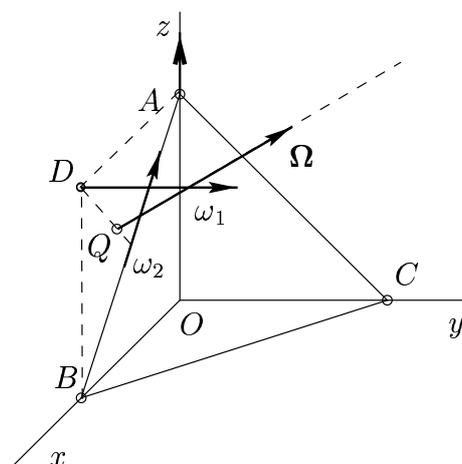
Su composición, al ser rotaciones aplicadas en ejes que no se cortan, dará lugar a un movimiento helicoidal general con velocidad de rotación  $\mathbf{\Omega} = \omega_1 + \omega_2$  y deslizamiento en el eje.
