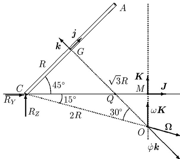
El axoide móvil es un cono de eje  $OG$  y semiángulo  $30^\circ$  que rueda sin deslizar dentro del axoide fijo, otro cono de eje  $OM$  y semiángulo  $75^\circ$ .
