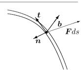
Por ser el hilo perfectamente flexible, la tensión T ha de llevar la dirección de la tengente, T = Tt. Empleando la fórmula de Frenet (dt/ds = n/R), siendo n la normal principal y R el radio de curvatura), se obtiene
