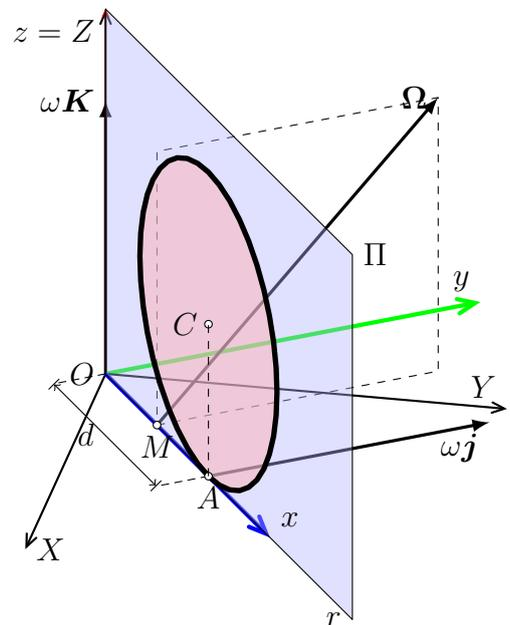
Para esto proyectamos la velocidad de un punto cualquiera del disco sobre la dirección de la velocidad angular, en concreto tomando el punto  $A$ :
