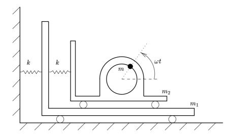
Elegimos como coordenadas los desplazamientos absolutos de los carretones,  $(x_1, x_2)$ . La masa excéntrica tiene un movimiento impuesto relativo al carretón 2 definido por las coordenadas  $(e\cos\omega t, e\sin\omega t)$ . La Lagrangiana resulta
